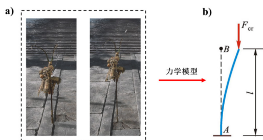
图 4 压杆稳定力学建模。(a) 游戏黑神话悟空中“立轂”示意图； (b) 对应力学模型。
